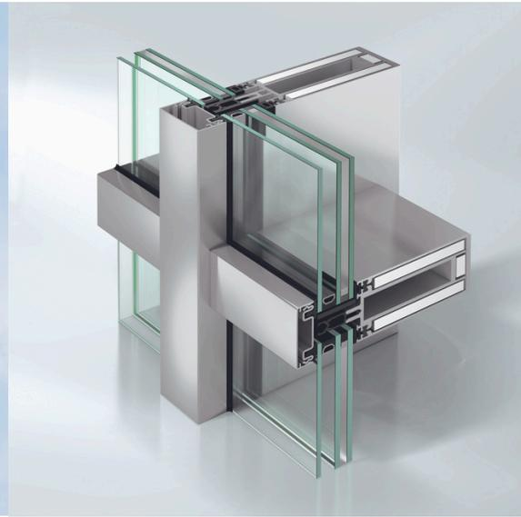
Pyroguard offre une gamme de solutions intégrées au système de profilé FW50 et FW60 de Schüco avec le verre résistant au feu trempé "Pyroguard Protect" disponible dans les classifications EI30 et EI60 pour les façades en aluminium.
